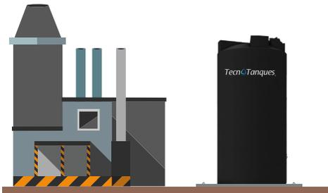
No instalar el tanque blanco en exterior a cielo abierto. Ya que este no cuenta con capa inhibidora de fotosíntesis.
